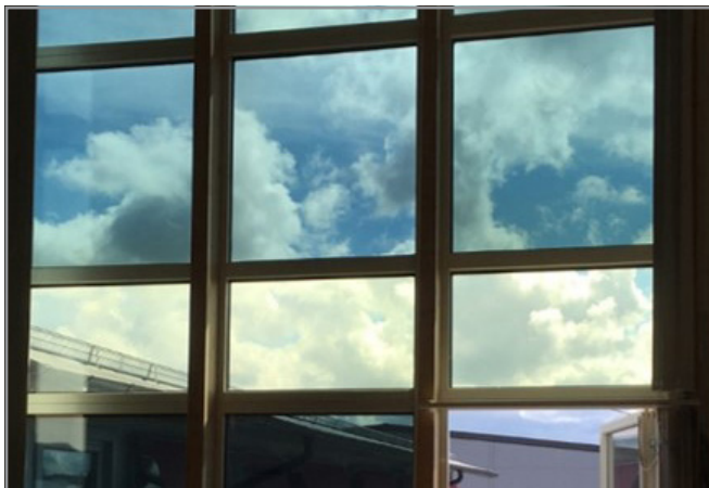
Bild 1: Visueller Vergleich zwischen elektrochromen Fenstern im nicht-geschalteten (unten) und geschalteten (oben) Zustand.
